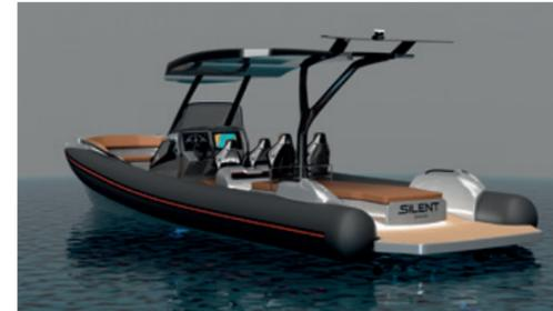
إنه أحدث مراكب Silent Yachts Group وأول خطوة لها في عالم المراكب الآلية القوية. وقد زود بتكنولوجيا كهربائية حديثة للدفع أحضرها لها الشريك الدائم eD-TEC مع مواتورات كهربائية 200 kw. المركب قادر على تجاوز سرعة 60 عقدة في الساعة. وإذا ما أبحر بسرعة 30 عقدة فإن مدى إبحاره يزيد على 70 ميلاً.
